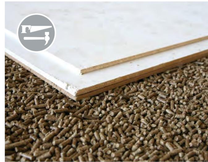
Les granulés isolants Biofib' chape sont 100% végétaux, fabriqués à partir de fines particules issues du défilage du chanvre et du lin, agglomérées par compression sans aucun liant. Biofib' chape est tout spécialement recommandé pour la réalisation de chapes sèches, en rénovation, de sols en mauvais état ou irréguliers. Sa mise en œuvre simple, rapide et sans eau se fait sans aucun dégagement de poussières.
