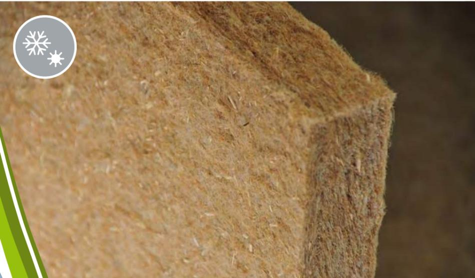
**Biofib' chanvre est un isolant naturel et écologique, fabriqué par nappage de fibres de chanvre. Disponible sous forme de panneaux semi-rigides, il est préconisé pour l'isolation thermique des bâtiments à ossature bois (murs, toitures et planchers) en neuf comme en extension MOB.**
