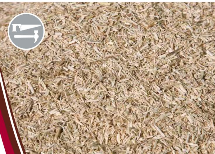
Biofibat' est un granulat constitué exclusivement de chènevotte (cellulose fibrée) calibrée et dépoussiérée, issue du défilage des pailles de chanvre, dont le procédé de transformation ne nécessite ni eau, ni solvant. Biofibat' dispose du nouveau Label Construire en Chanvre (CenC).
