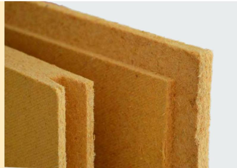
Les panneaux rigides Biofib'Pano sont constitués de fibres de bois imprégnées de paraffine en cours de fabrication. Utilisés comme écran de sous-toiture, ils jouent un rôle de **pare-pluie et peut être exposé directement aux intempéries pendant trois mois (joints traités)**, en restant imperméable à l'eau.
